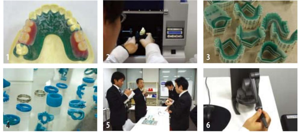
1 石膏模型に造形物を試適。2 スキャニング操作。3 完成レジンパターン。4 様々な造形物。複雑な形状が可能。5 dico担当者弊社との話し合い。6 触感3次元マウスPHANTOM。モニター上のモデルに沿って実際に抵抗が感じられる。
