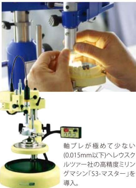
軸ブレが極めて少ない(0.015mm以下)ヘレウスクルツアー社の高精度ミリングマシン「S3-マスター」を導入。
