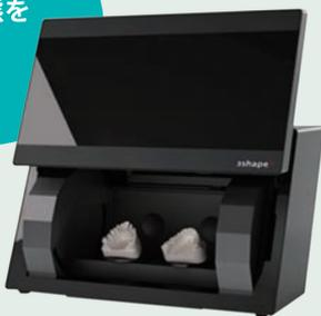
上下顎模型を同時にセットし、スキャン可能。マルチラインスキャン技術により、支台歯の死角部分まで光源を照射出来るため、個別の支台スキャンが不要。鉛筆で記入した義歯の設計線が読み込めるため、金属床のフレーム等がスムーズにデザイン可能。
